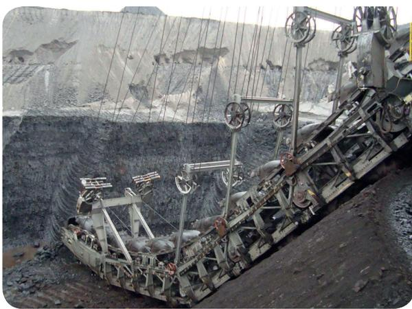
Bild 1: Mit diesen Eimerkettenbaggern und Schaufelradbaggern fördert der Energiekonzern Vattenfall im Tagebau Welzow-Süd rund 20 Mio. Tonnen Braunkohle im Jahr.
