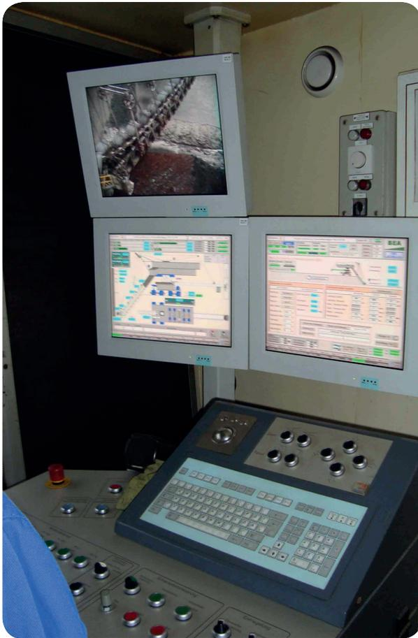
Bild 3: Im Baggerführerstand laufen alle relevanten Zustands- und Betriebsdaten aus den Diagnose- und Visualisierungssystemen zusammen.
